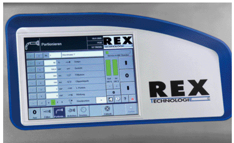
Der voll integrierte REX Touchscreen wird bei allen Maschinentypen eingesetzt und bietet dem Anwender einfachste Bedien- und Einstellmöglichkeiten
