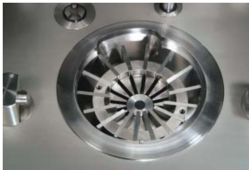
Ein Blick in das Flügelzellenförderwerk
