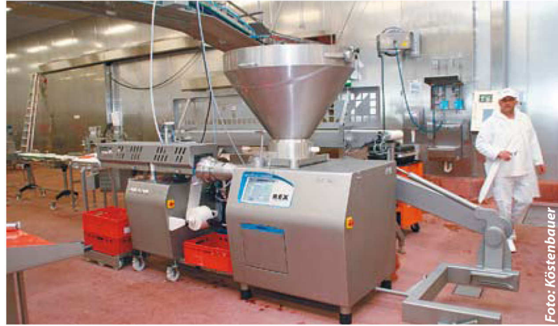
Bis zu 120 Portionen Faschieretes und Cevapcici pro Minute werden in Oeynhausen mit einem Rex RVF 761 und dem angeschlossenen Hackfleischportionierer RHP 240 erzeugt
